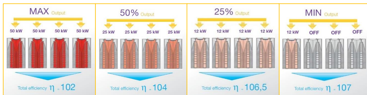
شکل ۳- راندمان دیگ‌های چگالشی در ظرفیت‌های متفاوت [۳]
